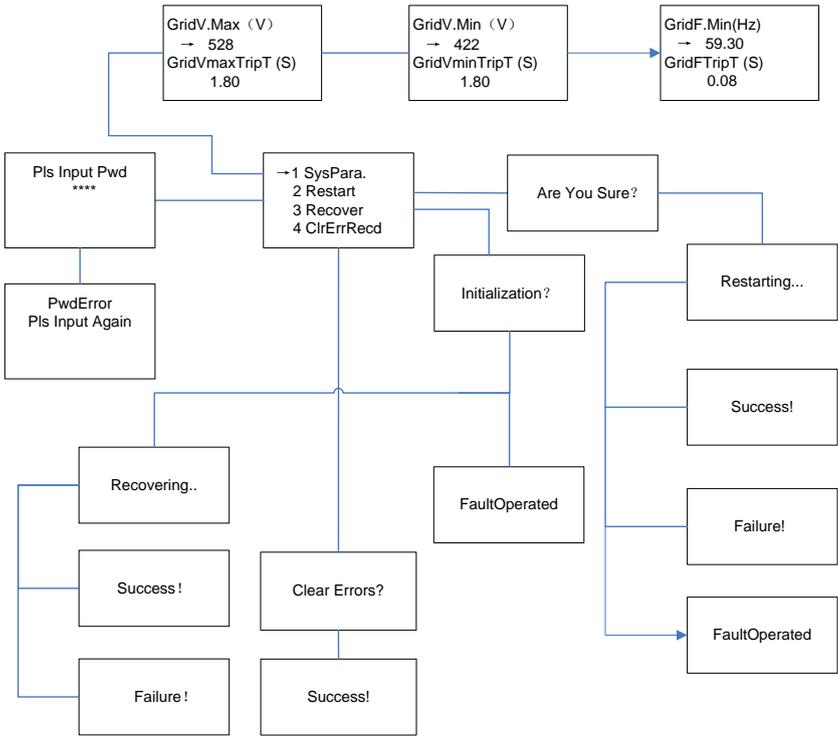
Figure 4-14 System parameter setup
